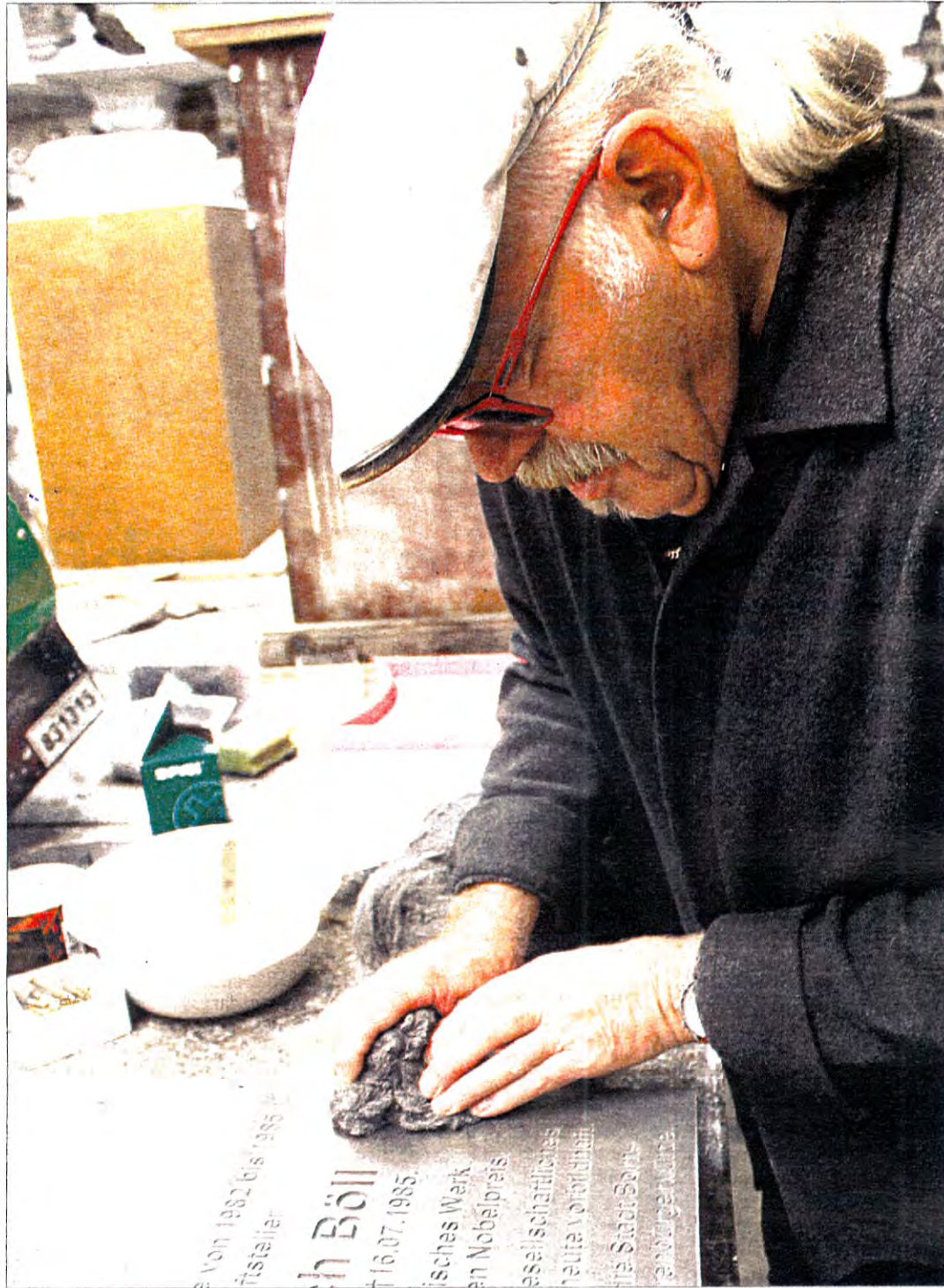
Den letzten Schliff verpasst Friedrich Antoni der Gedenkplatte mit Stahlwolle. Das Pressverfahren hat er selbst entwickelt. (Foto: Margret Klose)
